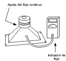
2c. FLUJOMETRO ELECTRONICO CON RESISTENCIA AJUSTABLE EXTERNA
